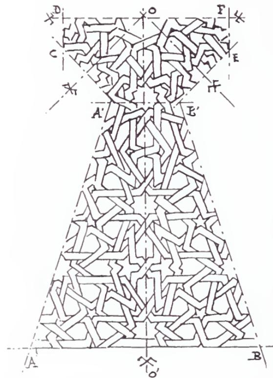
Fig. 207. — Détail d'un huitième du plan d'un plafond en tronc de pyramide à exécuter en charpente. — Dessin de H. Saladin, d'après une figure du traité de Diego Lopès de Arenas: *Compendio del arte de Carpinteria* (Séville, 1632). — D C A' B' E, moitié du plafond octogonal. — A' B' A B, un des pans du tronc de pyramide. — o o', axe d'une des faces du plafond.
