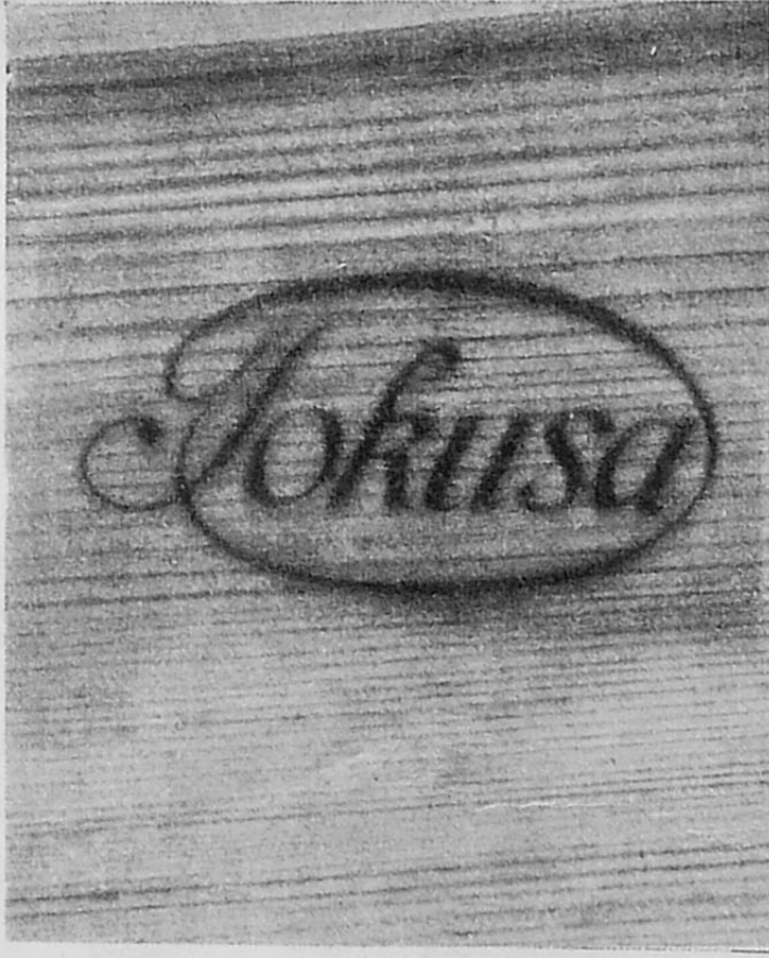
Деревянная пластинка, сдѣланная прозрачною по способу Шпальтегольца; сквозь нее ясно видно слово, написанное на бумагѣ.
