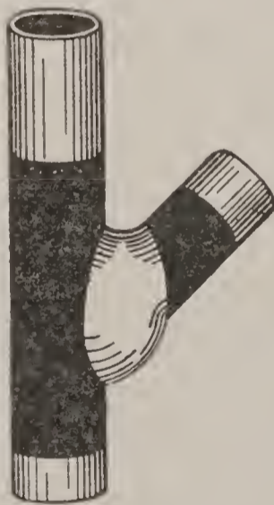
Fig. 245. Y-Joint on Lead Waste-Pipe.
