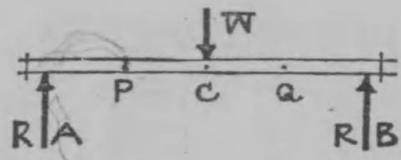
今試みに此の場合の剪力を求むれば左右支端部即ち A 及 B 断面の剪力
