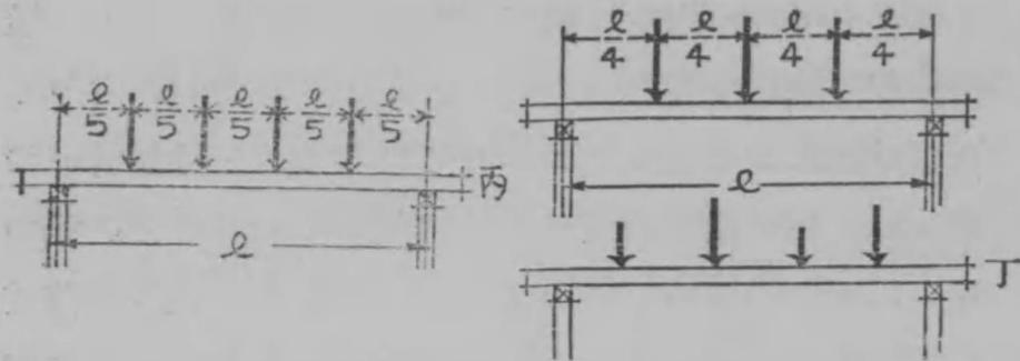
丙の對稱集中荷重とは同じ大きさの集中荷重が、梁全體に亘り同じ間隔で働いてゐる場合で、同じ間隔に荷重が働いても、その大きさが異れば不對稱集中荷重丁となり、又荷重の働く間隔が異つてゐれば、たとへ同じ大きさの荷重が働いても不對稱集中荷重丁となるものである。この中で中央集中荷重甲と對稱集中荷重丙との場合では、左右反力の大きさが相等しく全荷重の半分宛になるものである。
