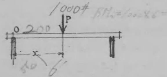
上圖の如き梁に外力 P が働けば、支點 O (梁の支端部即ち桁の中心線上の點) に對する、外力 P の能率は
