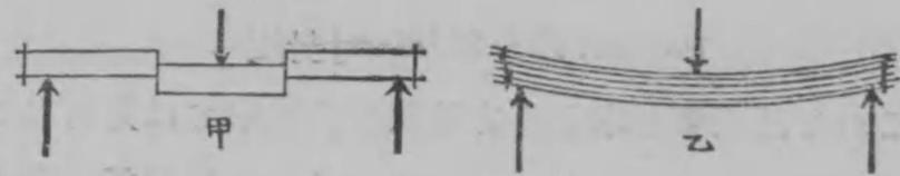
甲圖は梁が荷重の爲めに垂直に肌離れ即ち切り剪られた圖で、乙圖は梁が荷重のために木材ならば木目に沿ふて水平に肌離れ即ち切り剪られた圖である。斯様に剪力には水平剪力と垂直剪力との二つがある。勿論梁に荷重が架かれば、その荷重に相當する水平垂直の二剪力は常に働いて居るものである。故に梁は荷重を受けると曲能率が起きて、その結果折れて破壊するか剪力によつて肌離れして破壊するかするものである。
