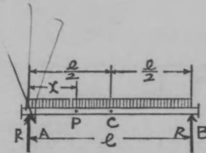
ふやうに荷重を表すのである。中央部C點の曲能率を求むれば、定理により左を考ふれば、外力は反力 $R_A$ とC點より左支端部迄にある等布荷重のみである。等布荷重は集中荷重と異つて能率をさる時力の働く點が無數にある譯だから、此の場合Cより左支端部迄の間の全荷重が、この距離の中央部に集中したものと考へねばならぬ。つまりCより左の等布荷重の總量は、 $\frac{w \cdot l}{2}$ であつてその働く點はCより $\frac{l}{2}$ の距離である。
