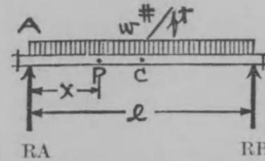
左及右支端部 A 及 B 断面の剪力は最大で  $V_A = V_P = R_A = R_B = \frac{w \cdot l}{2}$  中央部の断面 C の剪力は 0 である。
