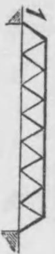
1 ワレン構造 (Warren truss)
