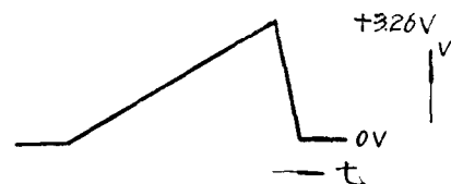
图 15 TR1需要的输入锯齿波电压
