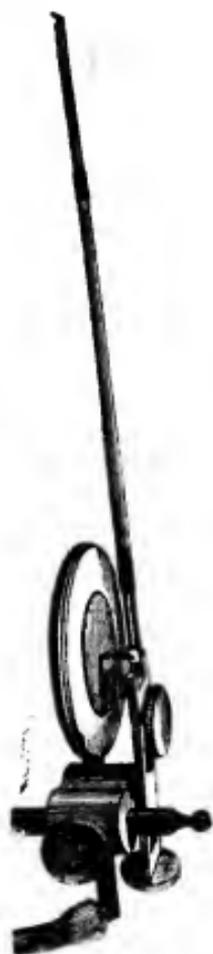
FIG. 41. — Levier du polygraphe articulé avec la membrane du tambour.
