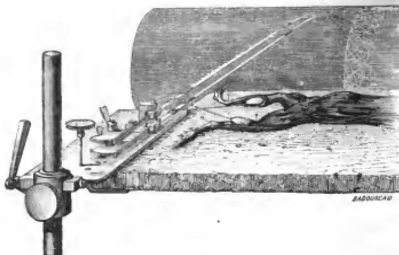
FIG. 77. — Myographe double ou comparatif.
