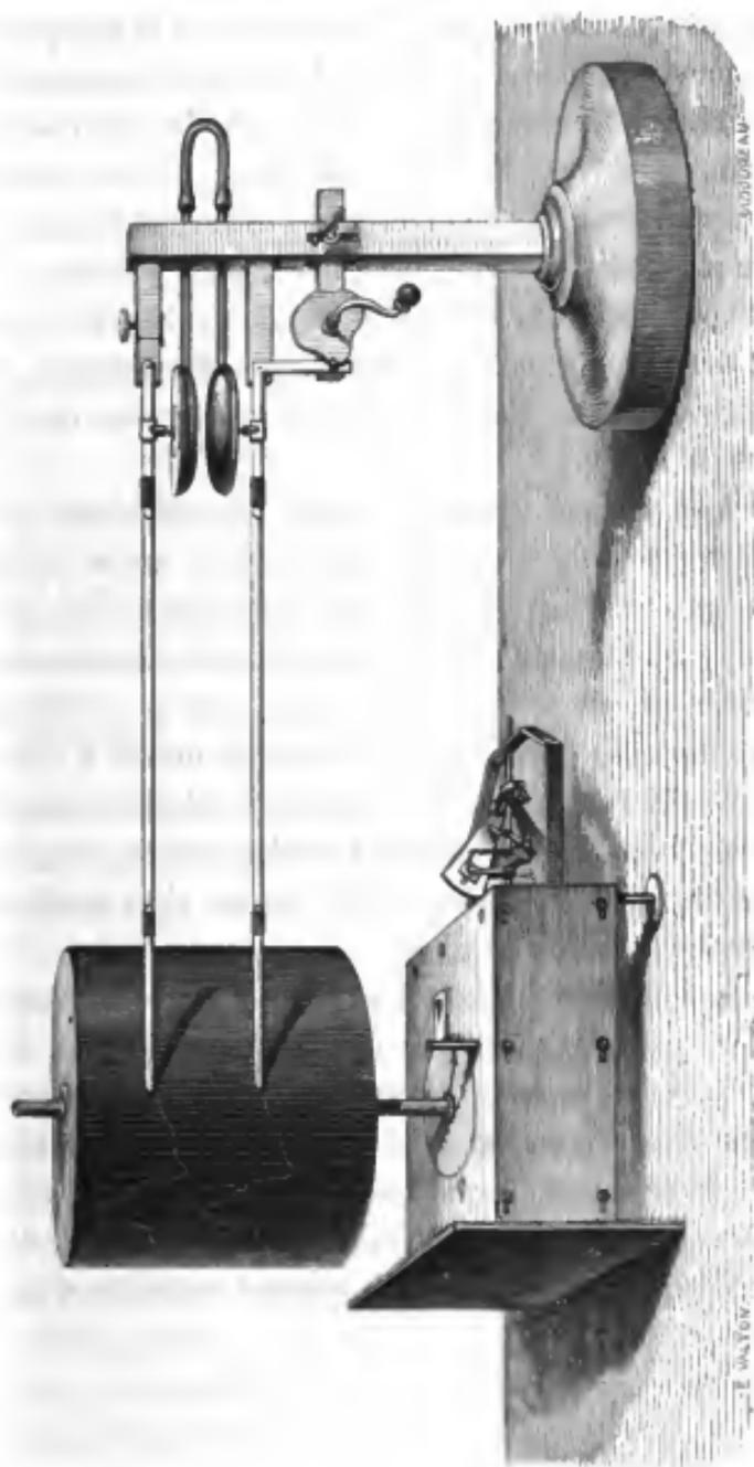
FIG. 57. — Appareil servant à vérifier les appareils enregistreurs d'après la méthode de Bonders.
