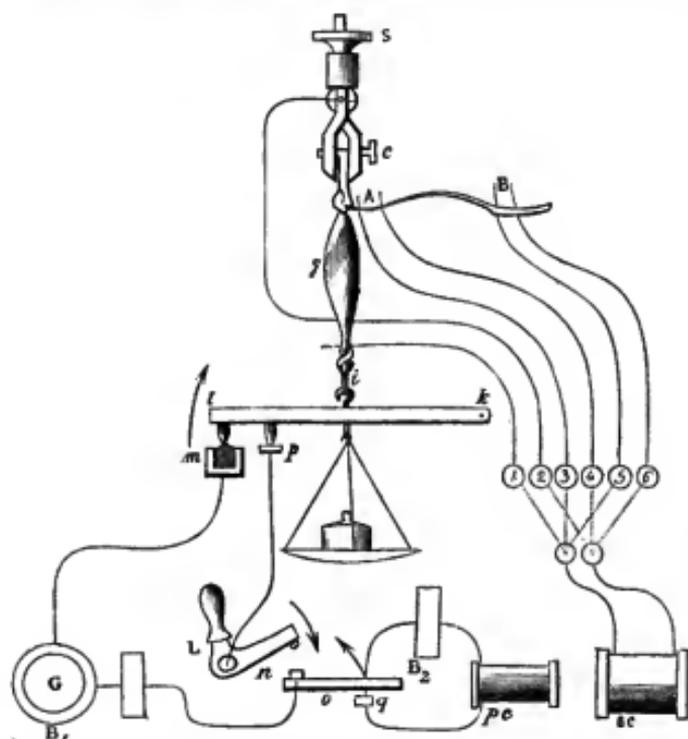
FIG. 134. — Appareil de du Bois-Reymond pour mesurer, par la méthode de Helmholtz, la vitesse de l'agent nerveux.
