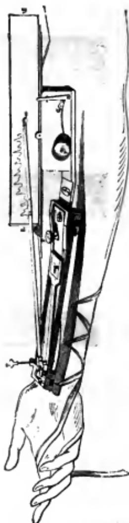
FIG. 31. — Sphygmographe de Murey.
