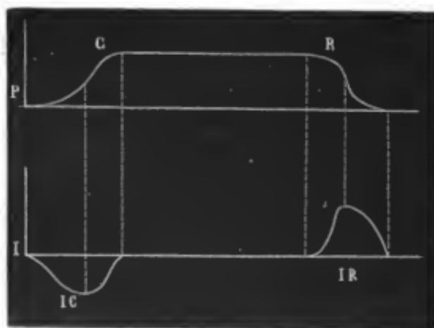
FIG. 97. — Graphique exprimant les phases diverses du courant inducteur et des courants induits de clôture et rupture.
