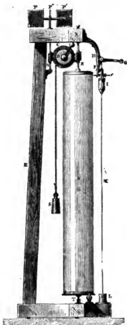
FIG. 19. — Machine de MM. Poncelet et Morin pour enregistrer les lois de la chute des corps.
