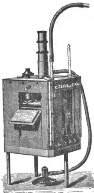
Fig. 45. — Cámara caliente de Pfeiffer.
