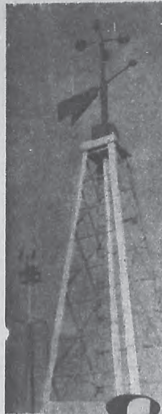
羅泰式的揚水機。應用夫列脫諾爾氏的羅泰船的原理而作成的汲水唧筒。
