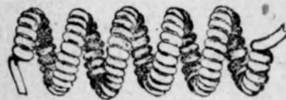
ため織條を螺旋にしてゐるが、二重コイル織條電球は、この螺旋織條を更に螺旋にしたものである。
