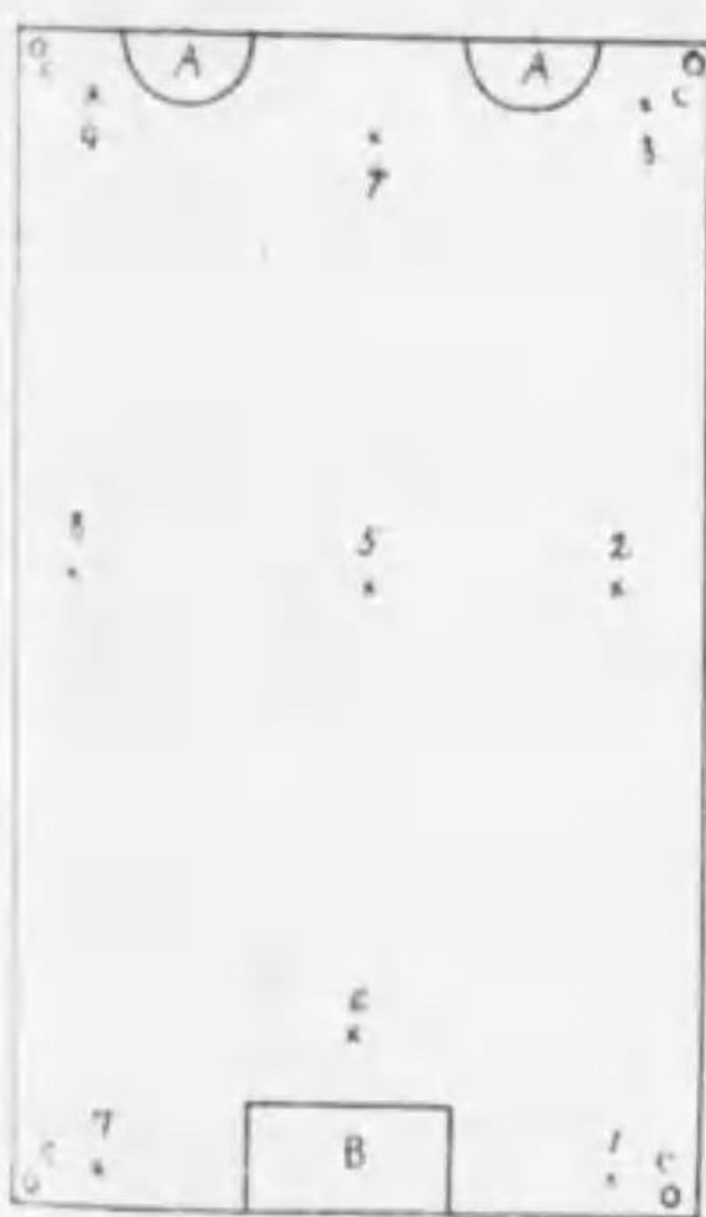
第1圖 濾過池床に於ける供試材料採取地點 A 源水引入口 B 浄水引出口 C 餘水吐口
