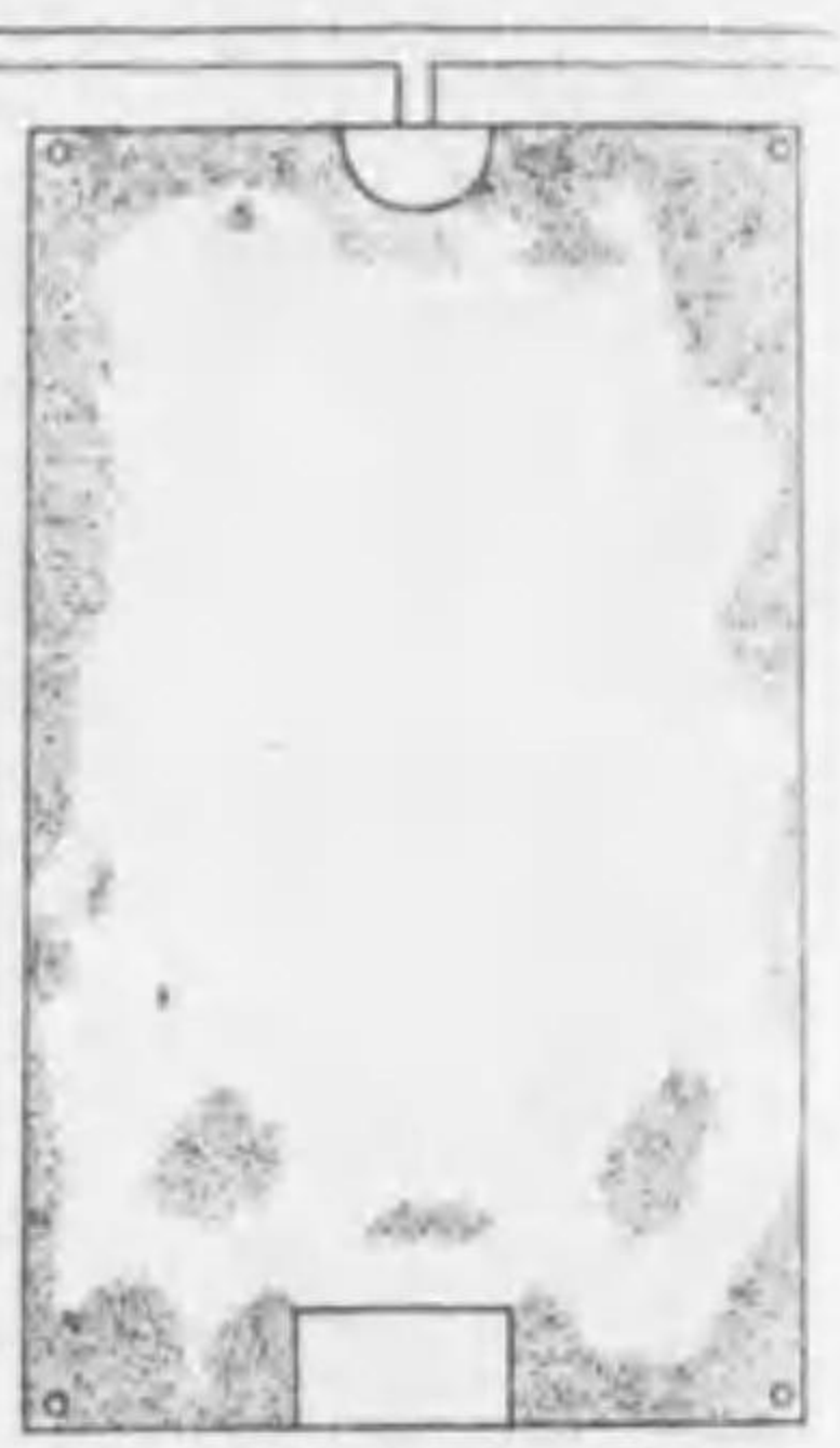
第5圖 濾過池に於ける汚泥集積狀況(其三) 八號濾過池 甲三十一日水漲り 水場一月二十五日排水 淨水場同二月二十六日 昭和四年二月二十六日 使用日數二十日
