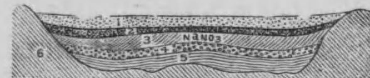
第158圖—チリ硝石鑛床。(1)砂層 (2)粘土層 (3)チリ硝石層 (4)鹽化加里層 (5)石灰岩
