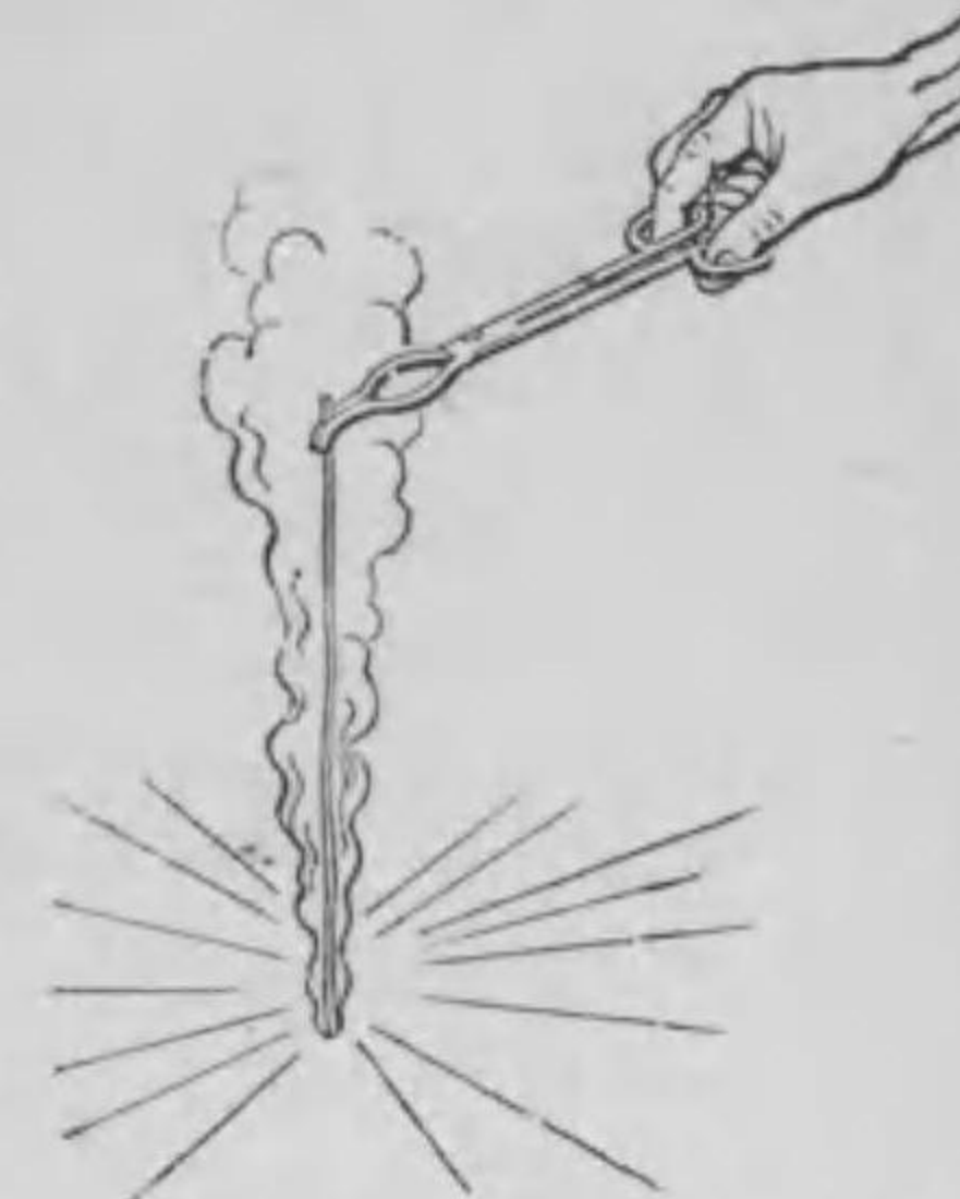
第139圖—マグネシウムを燃焼せしむ。
