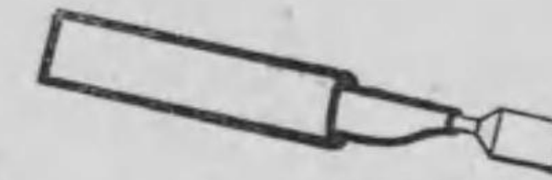
第138圖—亜鉛蒸溜器。(左)レトルト、(右)受器。
