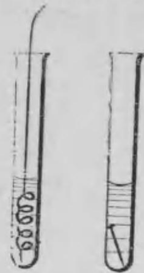
第116圖— (左) 硝酸水銀溶液に銅線を浸す。(5) (右) 硫酸銅溶液に鐵釘を浸す。
