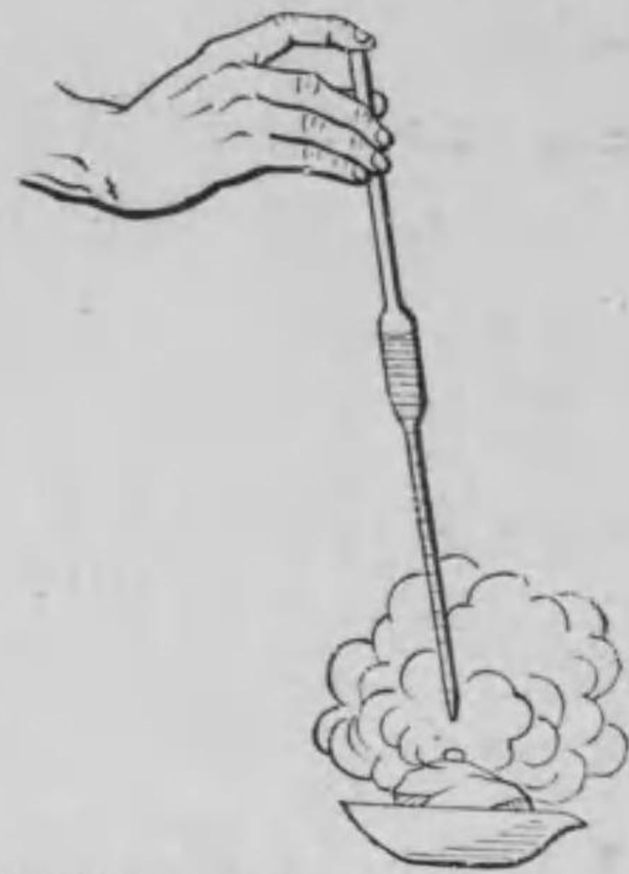
第147回—生石灰に水を加へて消石灰を製す。
