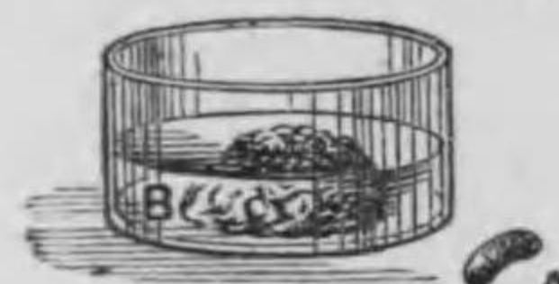
第167圖—アムモニウムアマルガム(A)及び之を水に入れたる状態(1)。
