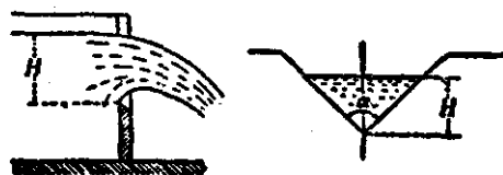
长方形(矩形)堰 三角形堰
