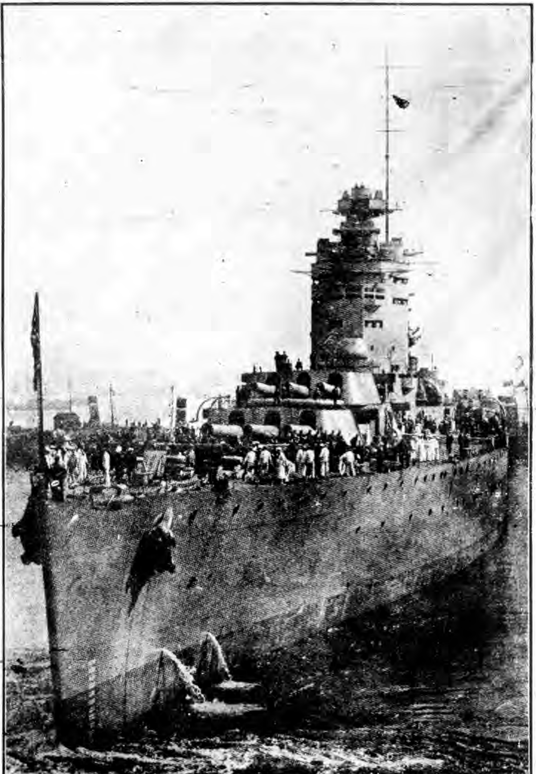
英國戰艦 排水量 艦長七百零 艦寬百零 吃水三百呎 輪機特賓機 馬力四萬五千匹 速率二十三哩 砲械十六吋砲九尊 六吋砲十二尊 四吋七高射砲六尊 三磅砲四尊 十二磅陸戰砲 機關砲五尊 魚雷發射機 水中魚雷發射 管無定數
