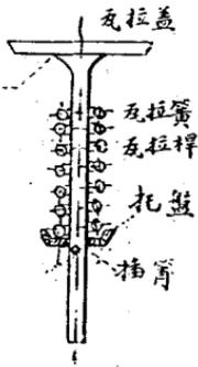
瓦拉之構造分兩段一爲瓦拉蓋與汽缸上端之汽孔斜面密接一爲瓦拉桿桿之下端有插筭一根插筭之上有托盤一個托盤之上有瓦拉彈簧一條瓦拉開門時瓦拉桿受瓦拉座之撞擊壓緊彈簧而瓦拉桿若不被撞擊時則彈簧保持其原有之壓力使瓦拉緊閉於汽缸之上
