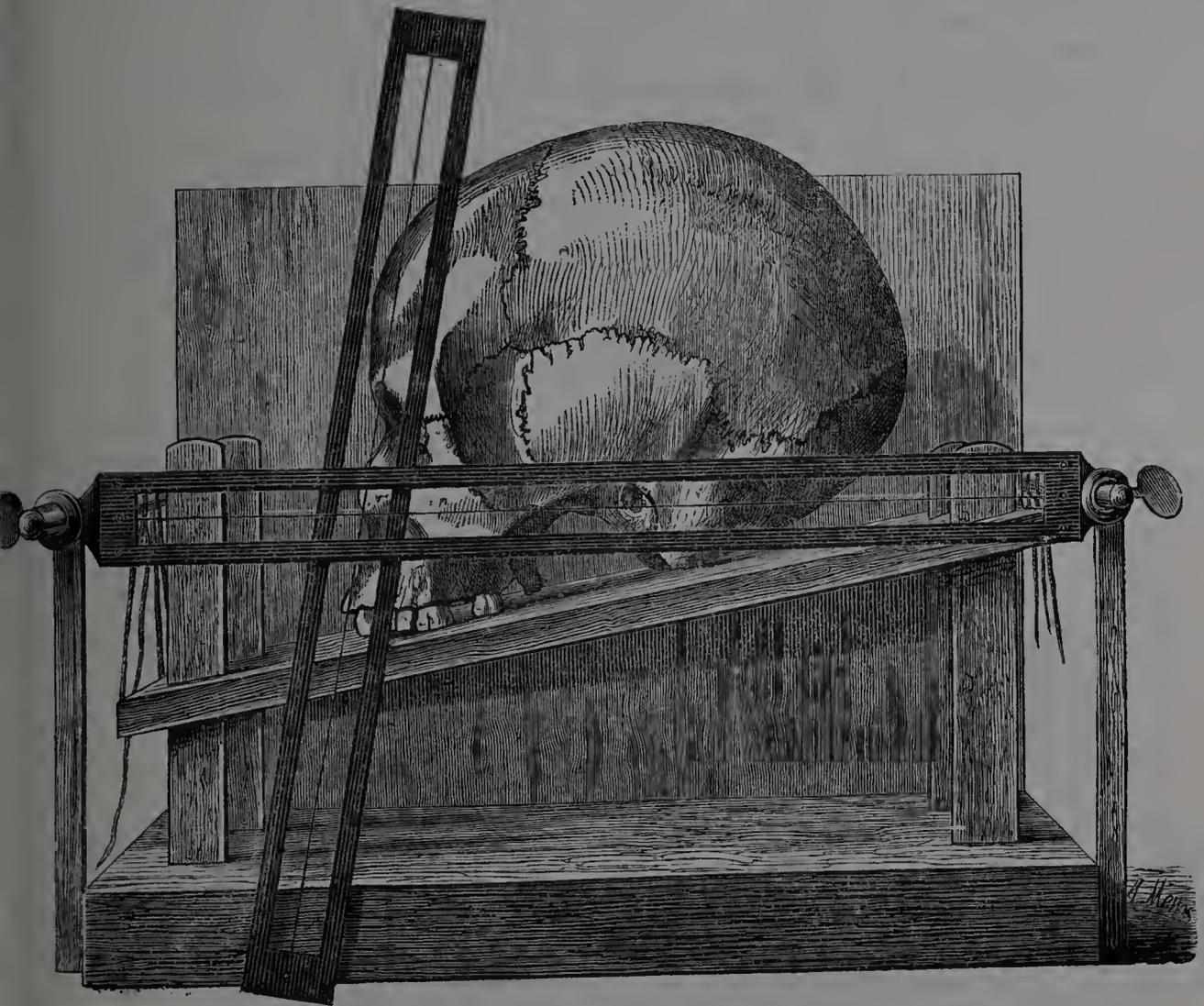
Das Princip desselben ist, dass der Schädel auf einem an vier Eckstäben auf und ab gleitenden Tische bald rechts bald links gehoben werden kann, je nachdem man die eine oder die andere Horizontale einvisiren will. Auf dem diesen Tisch tragenden Brette ist am hinteren Rande ein anderes senkrecht befestigt, welches von der Mitte seiner Höhe beiderseits je einen Messingstab nach vorn schickt, der wieder am Ende auf einem am Grundbrette befestigten Stabe ruht. Die Messing-
