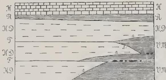
Schematischer Durchschnitt durch eine helle indische Kalkdolomitmasse (KI) mit vorgelagerten Cipitkalken (schwarz).
