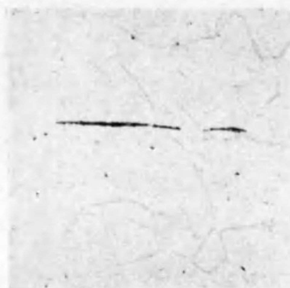
棒狀の瑞典鐵，フェライトの粒と之を横切る不純物の線條を示す。稀硝酸にて腐蝕す。×250
