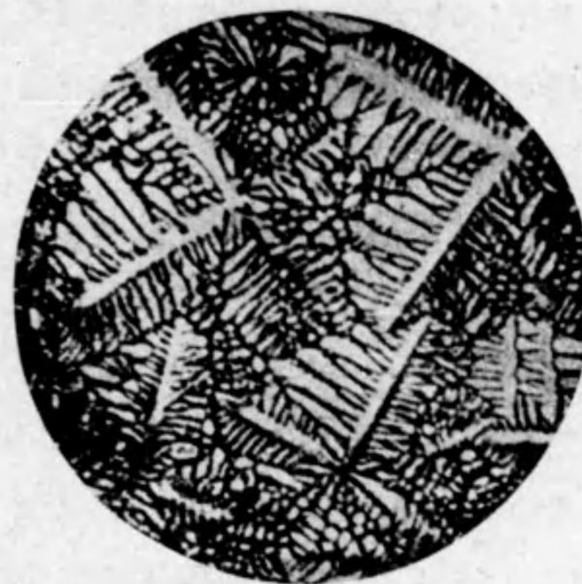
純アンチモンの樹状組織。 Photo. 1. (c)
