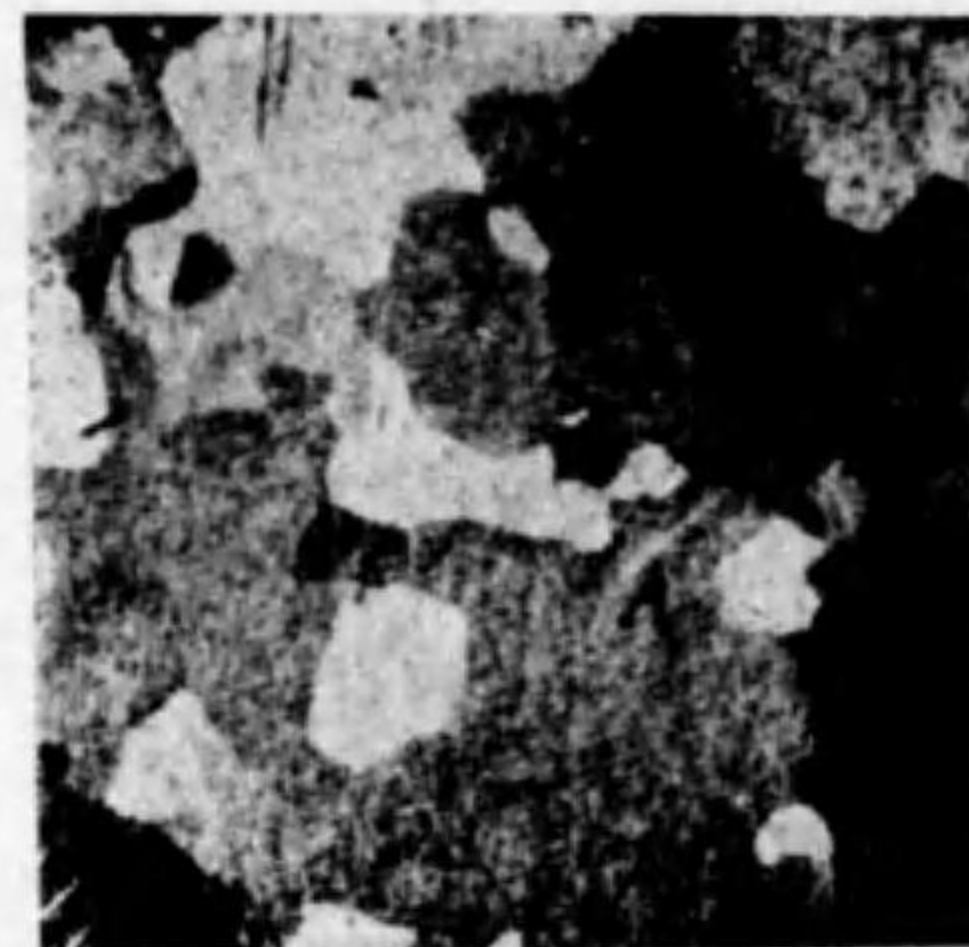
同一試片を更に 220°C に 20 時間加熱すると粒 B は愈々大となる。×3.5
