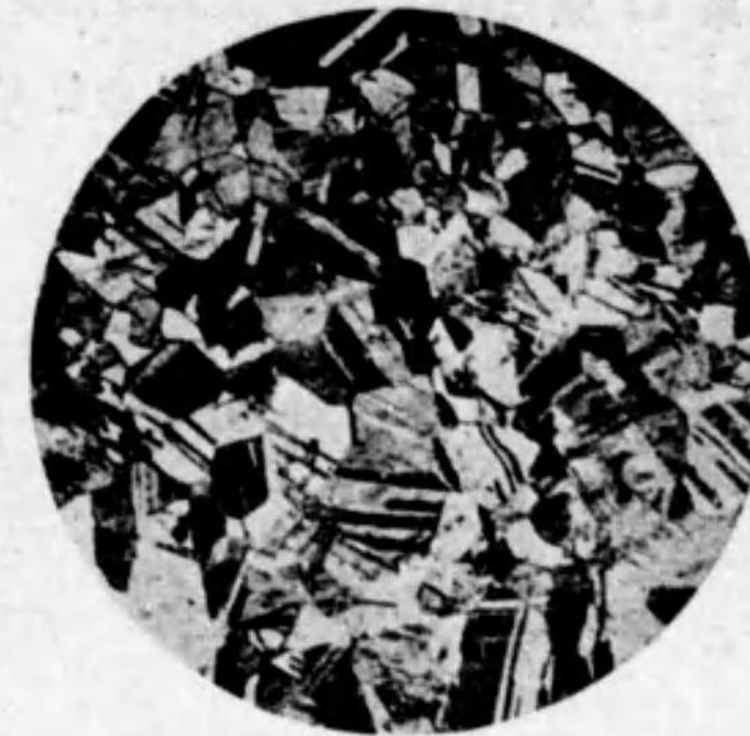
アルミ青銅の α 粒中に於ける再結晶で起る双晶，アンモニア水をしませたもので研く。
