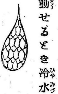
動せるとき冷水に投すれば脆きものとなるこれに爪にて疵を付ければ全体龜裂して恰も松の實の如くなる水の冷温によりて其龜裂に差異あり少しく温度上なる水にて冷せば此性なし水愈冷ければ愈脆きものとなり空中に置くこと暫らくなれば此性を失ふべし
