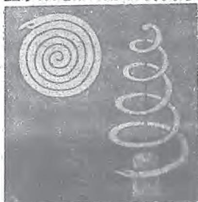
圖十九 熱空氣能把蛇盤形向上推動。
