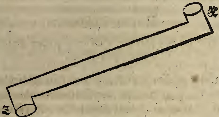
„Man kann Röhren von verschiedener Länge haben, und so gemacht daß sie an einander passen für die höhern Fenster. Da diese Röhren von dünnen, ohngefähr fünf Zoll breiten tannen Bretern gemacht werden müssen, so hat man nicht nothig sie in Form einer Röhre zusammen zu nageln, bis sie gebraucht werden sollen, und sie werden daher sehr wenig Platz einnehmen.“
