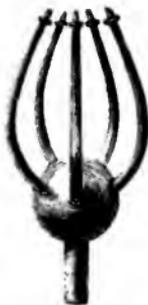
sondern gewissermaassen einen Ofen ersetzen sollen. Das bekannteste derselben ist die sogenannte Plattner'sche Spinne (Fig. 16). Aus einer etwa 1 Zoll im Durchmesser haltenden, hohlen Metallkugel, welche mit dem Leitungsrohre eines Blasebalges in Verbindung steht, gehen fünf gekrümmte, oben mit Löthrohrspitzen versehene Metallröhren aufwärts. Diese Vorrichtung (einer auf dem
