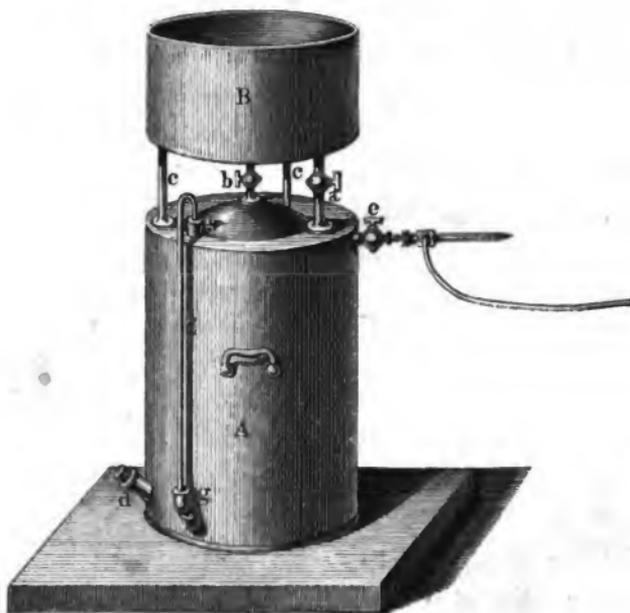
Sauerstoff, *B* mit Wasser gefüllt. Das Ausströmen des Sauerstoffs wird durch den Hahn *e* regulirt. Durch den aus dem Ansatzrohr seitwärts abgehenden Schlauch führt man aus einem zweiten Gasometer den Wasserstoff hinzu. — Soll die Knallgasflamme mittelst dieses Apparates hervorgebracht werden, so öffnet man zuerst den Hahn des Wasserstoff-Gasometers, und
