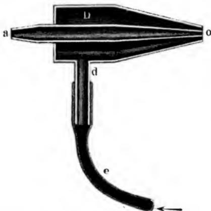
ringförmig um die innere Löthrohrspitze *o* laufende Oeffnung — auszuströmen. Wird es hier entzündet, so bildet es mit dem
