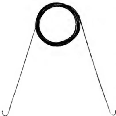
schaulich, mehrere Male im Ringe gewickelt und an seinen beiden freistehenden Enden mit angebogenen Oehren (Häkchen) versehen. Durch den Ring steckt man den Zeigefinger der linken Hand und setzt das eine Ohr, nachdem man es mit den betreffenden Stoffen gefüllt hat, der Einwirkung der Löthrohrflamme aus. Als Füllung
