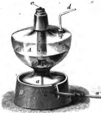
stellen. In einer gläsernen Spirituslampe *A*, von der Art wie sie in den Laboratorien gebräuchlich ist, wird der Boden zur Aufnahme des Korkes *b* durchbohrt. Durch diesen Kork führt man eine rechtwinkelig gebogene Messingröhre *aaa*, welche, mitten durch den Docht aufwärts steigend, in der Löthrohrspitze *c* endet. Das Holz-
