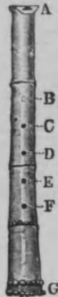
第309圖：一尺八。 Aは歌口、B、C、D、E、 は孔、Gは開端なり。
