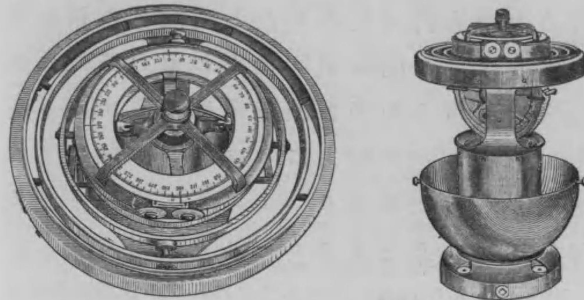
第287圖:—ジャイロコンパスの上面(左), と側面(右).
