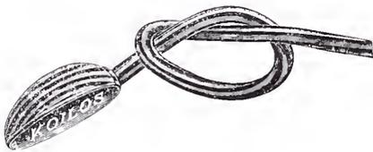
alle gebräuchlichen Handcameraverschlüsse mühelos aus. Diese Tatsache erklärt sich durch Anwendung eines entsprechend kräftigen Schlauches, dessen Beschaffenheit eine ganz besondere Sorgfalt zugewendet wurde. Bei vielen Schlauchbällen ist der Luftkanal des Schlauches zu weit, die Wandung aber zu dünn; dadurch wird bei einem Druck auf den Ball der Schlauch ausgedehnt, und nur sehr wenig Luft gelangt in den Verschluss. Bei
