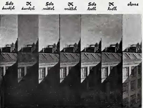
Durch Versuche wurde festgestellt, dass die Gelbscheibe »K dunkel« eine viermal längere Expositionszeit erfordert, damit in dem im Gelb gelegenen Maximum dieselbe Dichtigkeit entsteht, wie bei »Sch dunkel«.
