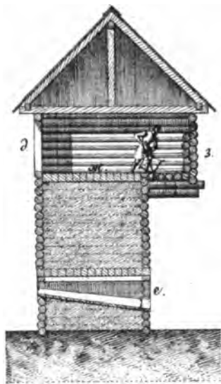
Черт. 33. Разрѣзъ деревянной крѣпостной стѣны. (По Ласковскому).
