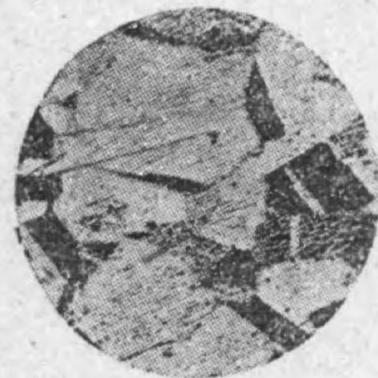
第2.10圖 壓延板を600°Cに焼き鈍した組織
