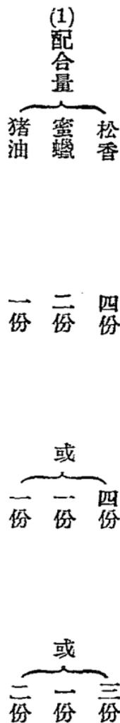
(2) 製法 先取松香入小鍋中，用炭火熔解之。乃取蜜蠟及猪油（熟猪油）加入，同時竭力攪拌，使全部熔合後即成。用時須加熱。
