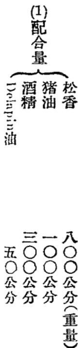
(2) 製法 先取松香及豬油置入鍋中，用炭火加熱，使溶解（宜加攪拌），混合後，乃將鍋取出，使其冷卻（此時仍續加攪拌），待至溫和時（用手觸之，不覺甚熱時），然後取酒精及 *Delipin* 油交互徐徐注入，並宜竭力攪拌即成。乃貯入瓶中，可隨時供用。用時以毛筆塗抹，甚覺便利，不必再行加熱，現今多採用之。
