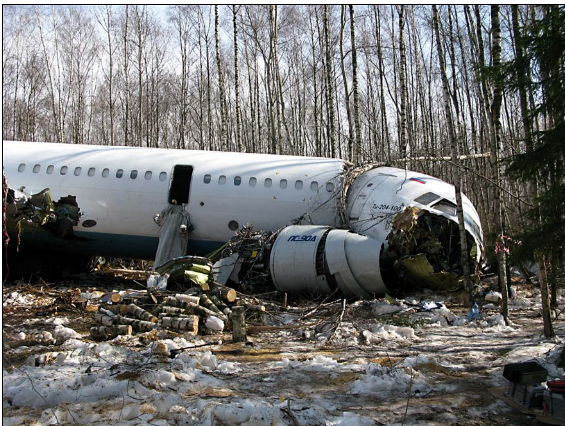
Рис. 6. Основные фрагменты самолета на месте авиационного происшествия
