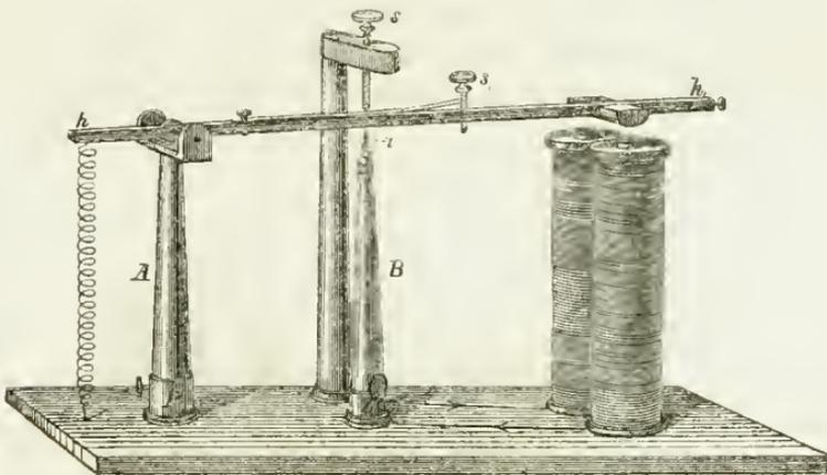
Die Poldrähte des Elements sind am Fusse der Säulen A und B, nämlich bei P (positiver Pol) und Z (Zinkpol oder negativer Pol) in die Klemmschrauben eingelegt gedacht. Der Strom läuft in der Säule A aufwärts, tritt in den Hebel  $hh_1$ , dessen kürzeres Ende durch eine Spiralfeder bei  $h$  niedergezogen, dessen längeres Ende mithin nach oben gegen die Schraube  $s$  gedrückt wird. Von  $s$  tritt der Strom durch die Säule ab-
