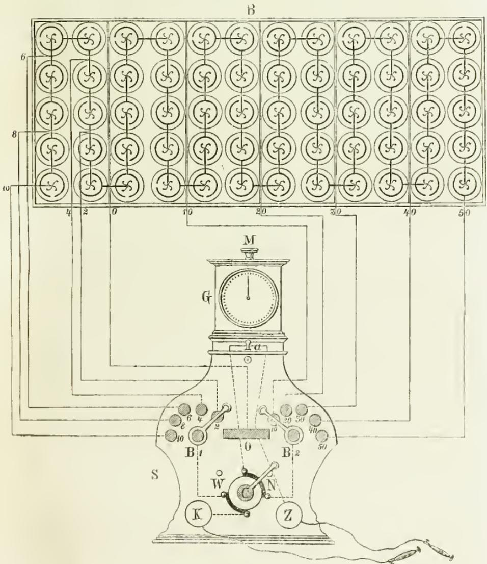
geschlossen ist, durch eine entsprechende Ablenkung der Nadel an, jedoch nur dann, wenn der Stöpsel, welcher bei a die Messingblöcke verbindet, ausgezogen ist <sup>1)</sup>. Wenn der Stöpsel bei a eingesetzt ist, ist das Galvanoscop, dessen Verbindung mit C und Z aus der Zeichnung ersichtlich ist, ausgeschaltet.
