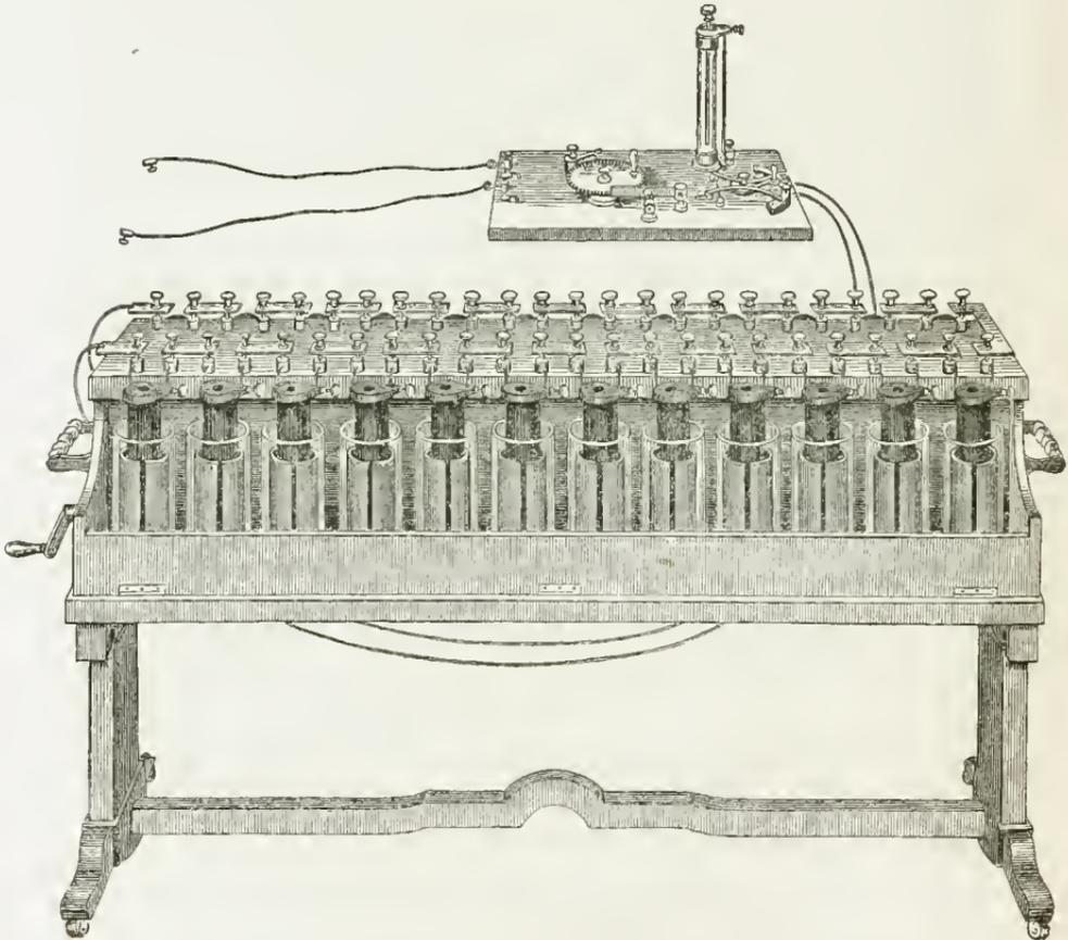
Die Verbindung der Elemente unter einander geschieht durch kupferne Klammern, von denen eine Anzahl längerer und kürzerer beigegeben werden. Die kürzeren Klammern, welche die Kohle des 1. Elementes mit dem Zink des 2., sodann die Kohle des 2. mit dem Zink des 3., und sofort verbinden, sind bestimmt, die Elemente hintereinander anzuordnen. Ist dies in beiden
