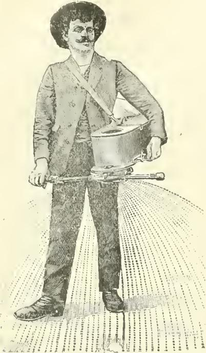
FIG. 51. — Manœuvre du semoir portatif à la volée (Ph. Mayfarth et C<sup>o</sup>.)
