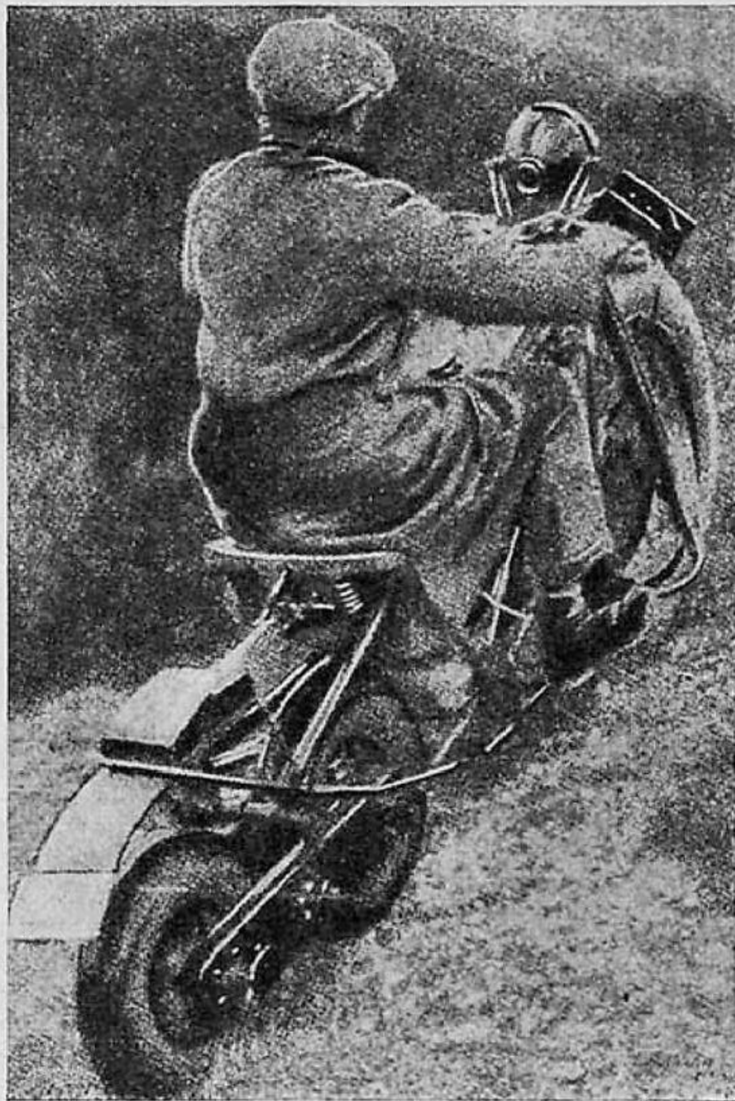
Мотоцикл-вездеход, имеющий три колеса, введенный в английской армии. Передача на оба задних колеса, диаметр которых меньше, чем переднего. Мотоцикл легко передвигается по любой дороге и бездорожью и хорошо берет под'емы
