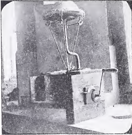
FIGURE 1. — Appareil pour imiter expérimentalement l'orogénie générale de l'Europe.
