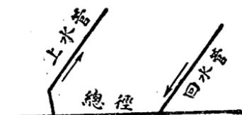
圖八十： 熱水暖氣一路法管子啣接情形
