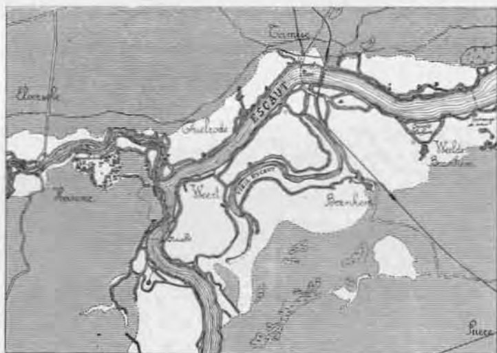
Fig. 112. E5. Confluent de la Durme et de l'Escaut. Le terrain polderien est en blanc; le terrain flamandais est hachuré. Les digues sont marquées. Les dunes (au Sud de Bornhem) sont délimitées par un trait pointillé. Échelle 1 : 100,000.
