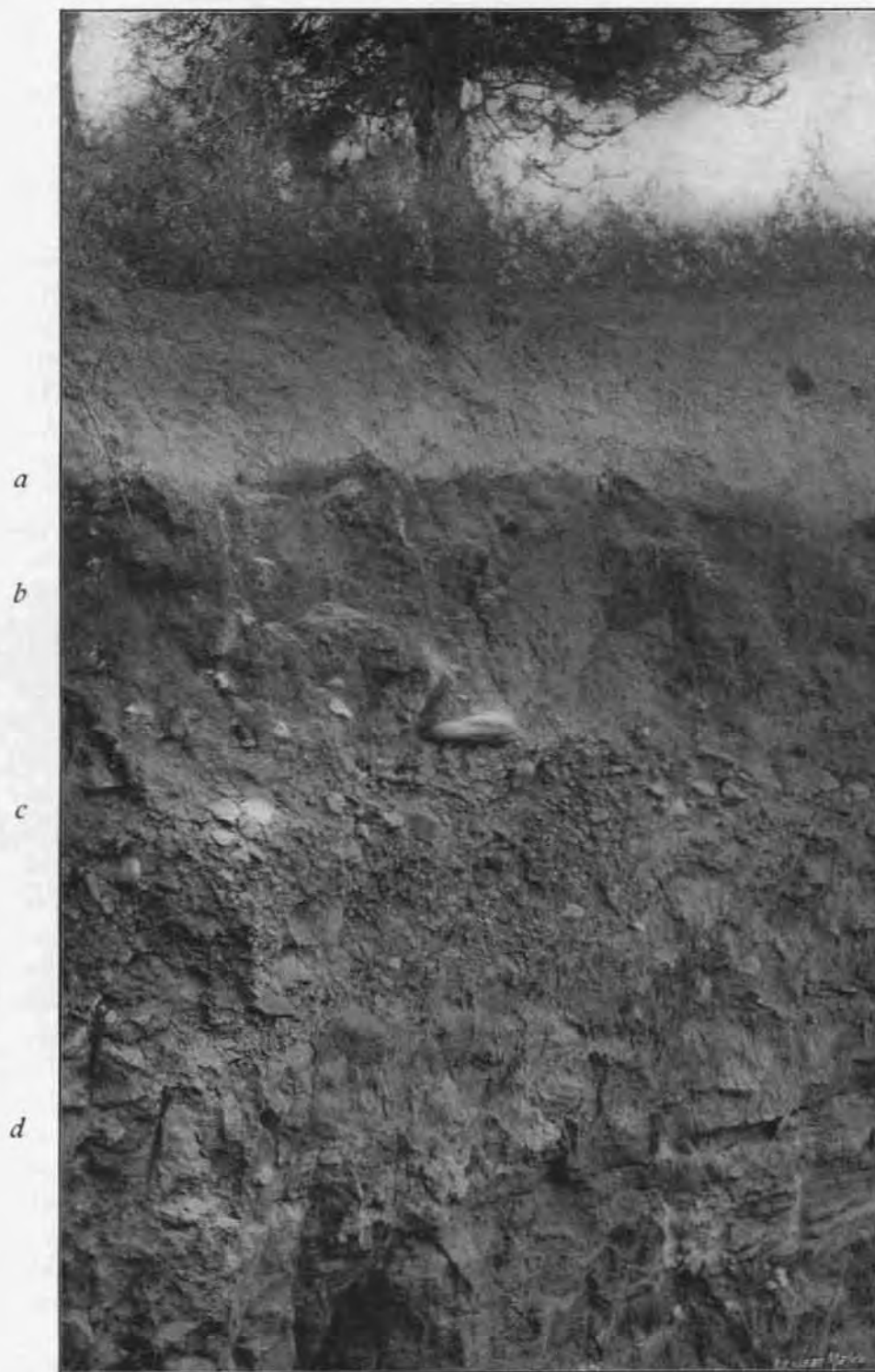
Fig. 148. G6. Constitution du sol. a. sable gris. — b. tuf humique. — c. cailloux roulés. — d. alternances de sables et de cailloux. Juillet 1911.
