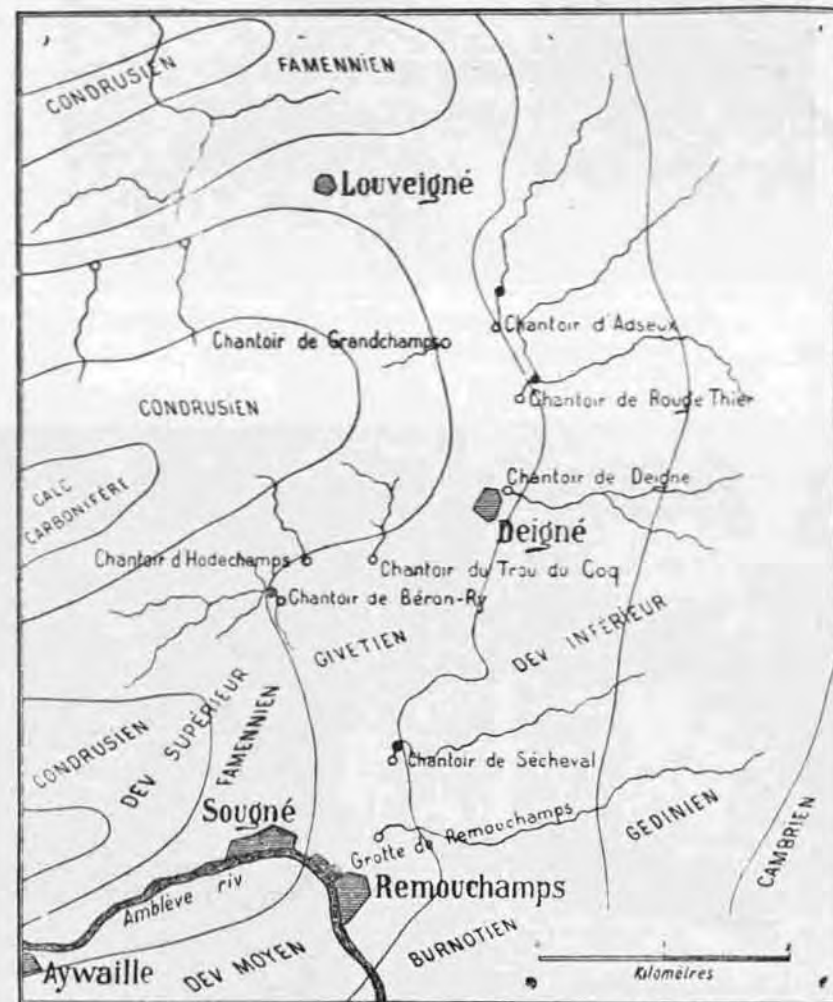
Fig. 283. J13. Croquis géologique de la région du vallon des Chantoirs, montrant l'emplacement des principaux chantoirs affectant le calcaire givetien. D'après MM. van den Broeck, Martel et Rahir.
