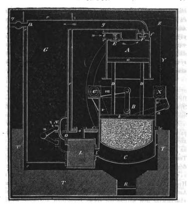
Другая, хотя в незначительная разница заключается въ томъ, что въ первой машинѣ для передачи движенія служитъ стержень a, а во второй эта передача пронаводится посредствомъ тяги или качающагося штока, соединеннаго съ поршнемъ b, и передающаго движеніе маховому колесу Z, помощію кривошиповъ m, v, насаженныхъ на валъ U, а также тяги n и кривошипо v, насаженнаго на главный валъ X.
