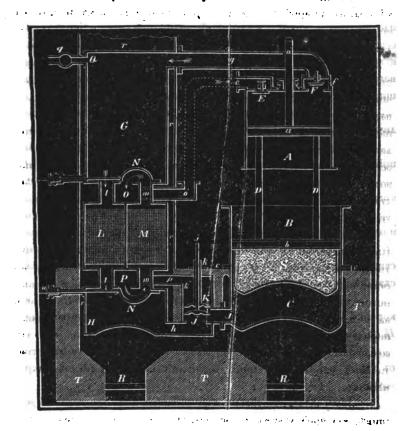
А и В представляють два цилиндра неравных какиетровь; вы их внутренности двигаются поринци и и b; инбющий на смей окружности набивку изъ упругих металлических колець: Цилиндрь А, инбющій меньшій разміврь, служить для доставленія воздуха вы машину и потому называется снабдителемь; другой, большій щилиндрь, вы которомы порімень принимаєть движеніс и силу оть расширеннаго воздуха, вазывается принимаєть движеніс и силу оть расширеннаго воздуха, вазывается принимаєть движеніс
