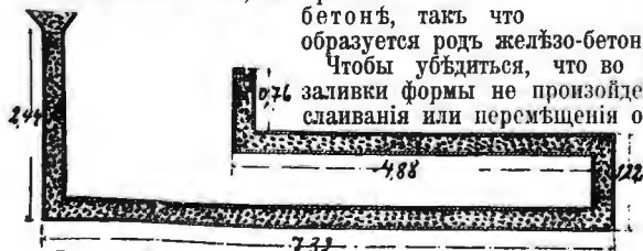
Рис. 5. Деревянная форма съ изгибами для испытанія плотности заливки бетона.
