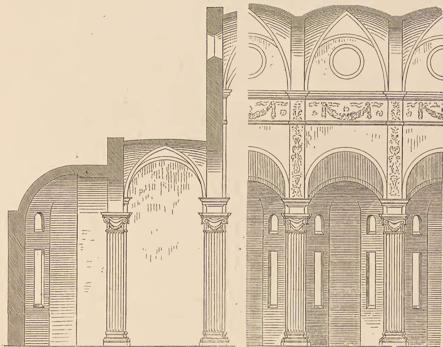
Fig. 84. S. Giovanni in Parma. Quer- und Längenschnitt. (L.)
