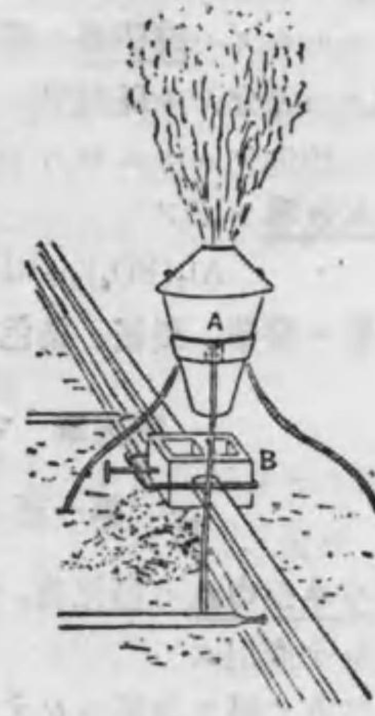
「テルミット法ニテ「レール」ノ接合
