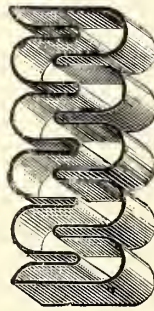
Nr. 474. Anordnung der Kupferplatten in dem Lawrence'schen Kühlapparat.
