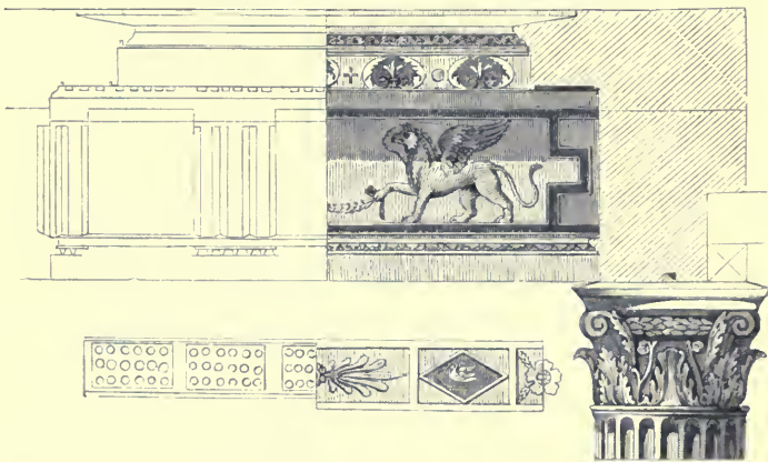
Fig. 35. Ein Stück vom Gebälk des Portikus des Apollotempels; ursprüngliche Form und Erneuerung nach dem Erdbeben.
