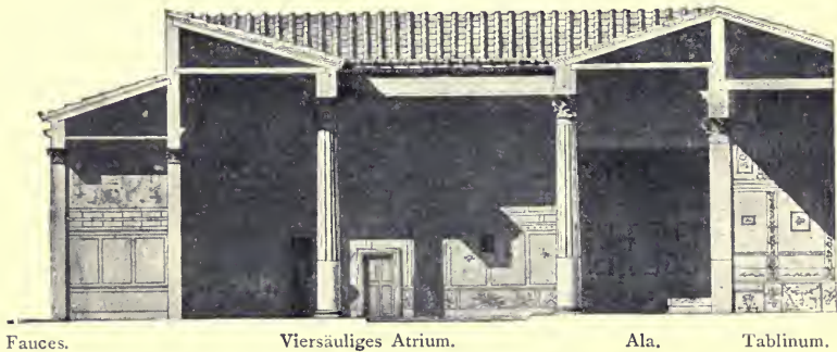
Fig 165. Längenschnitt des Hauses
