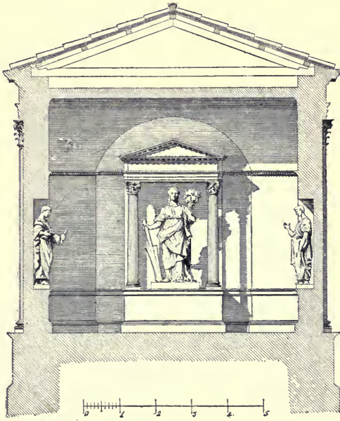
Fig. 65. Querschnitt des Tempels der Fortuna Augusta, wiederhergestellt.
