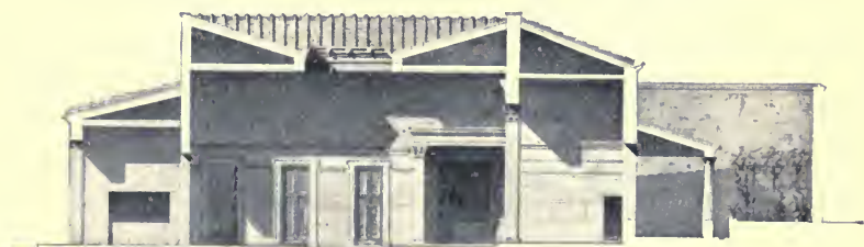
Fig. 153. Längenschnitt des Hauses des Sallust, wiederhergestellt. Links Fauces und der Verkaufstisch des Ladens. Dann Nordseite des Atriums mit der linken Ala, Nordseite des Tablinums mit Eckpilaster gegen das Atrium. Rechts Säulenhalle und Garten mit dem Triclinium unter der Weinlaube.
