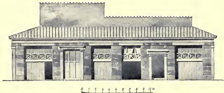
Fig. 157. Fassade des Hauses des Faun, wiederhergestellt. Links Laden mit Oberraum (1 auf dem Plan); dann die Haupttür, zwei Läden, Tür des Nebenatriums und ein vierter Laden, der, wie der zweite, ganz mit Brettern geschlossen ist.
