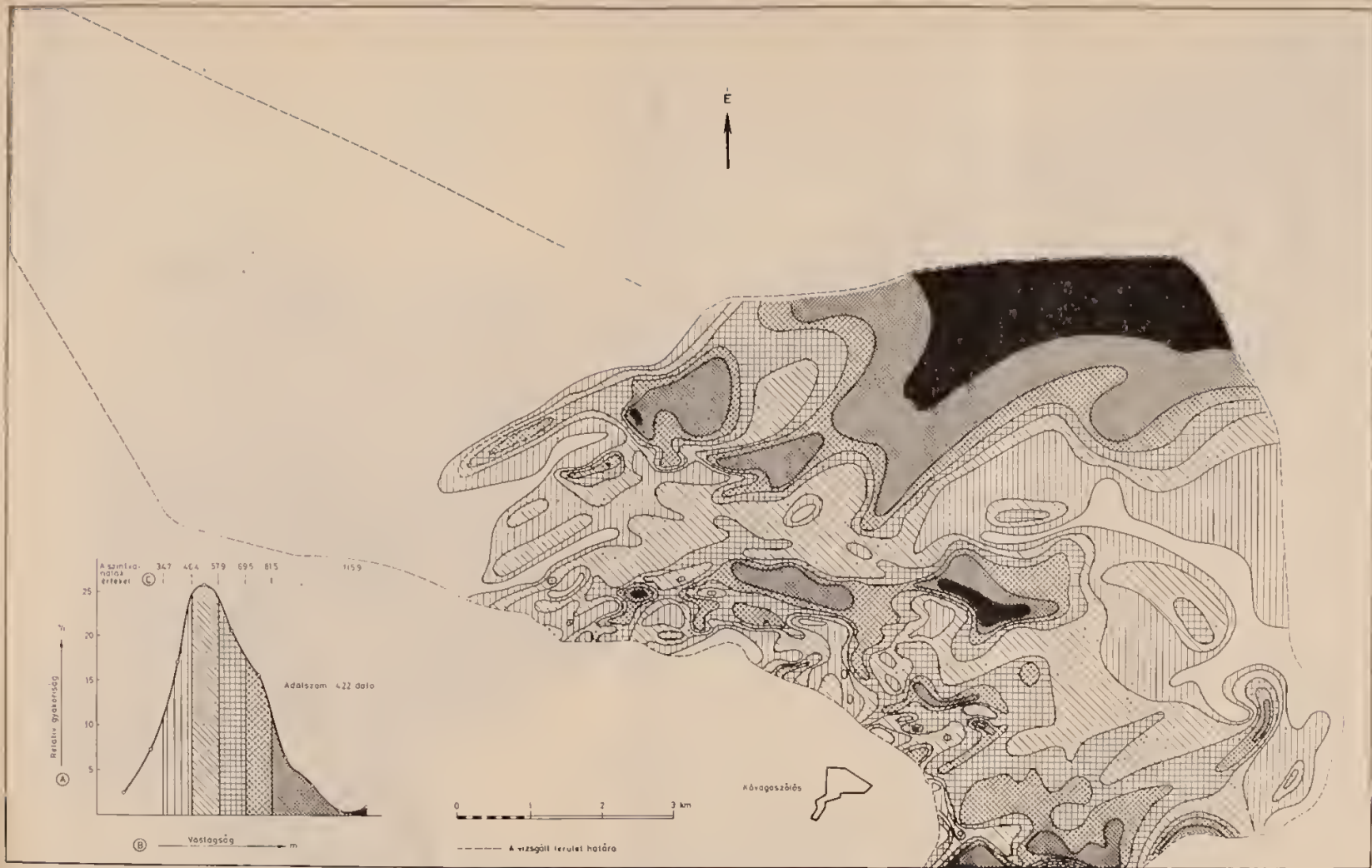
2. ábra. A Nyugati-mecsekli felsőpermiai illa, kavicsos homokkő vastagsági térképe (Weber B. 1984.) Jelmagyarázat A — relatív gyakoriság, B — vastagság, C — a szintvonalak értékei (m) Abb. 2. Mächtigkeitkarte des oberpermischen, illufarbigen, schottrigen Sandsteins im westlichen Mezők Gebirge (B. WEBER 1984). Zeichenerklärung A — relative Häufigkeit, B — Mächtigkeit, C — Werte der Isohypsen (m)
