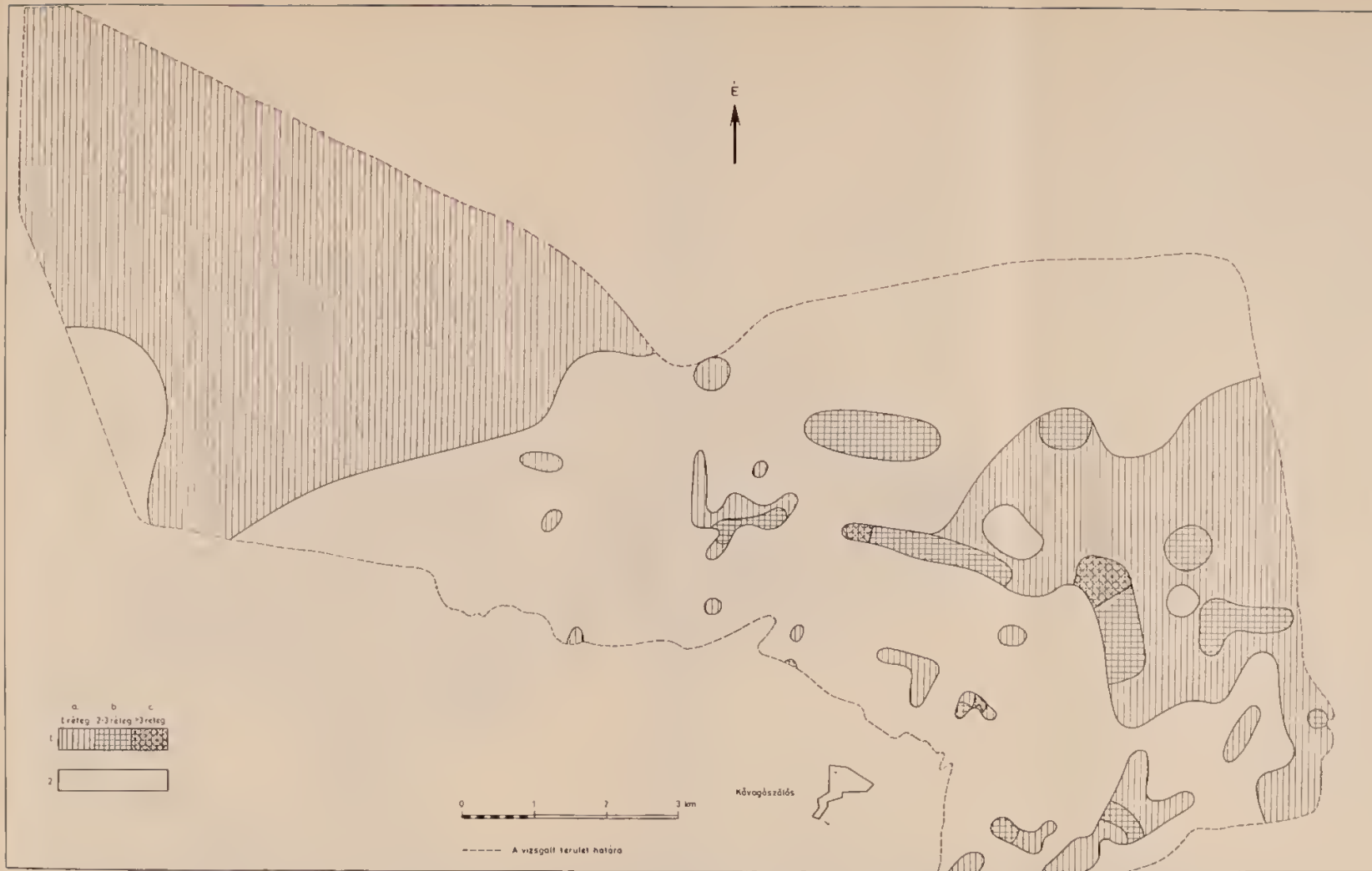
4. ábra. A nyugat-mecskli alsótrilász Jakabhegyi Főkonglomerátum közé települt homokkő rétegek elterjedése és száma (WIEBER B. 1964). Jelmagyarítás: 1 — homokkő közbetelepülés van, a — 1 réteg, b — 2-3 réteg, c — több mint 3 réteg, 2 — bomokkő közbetelepülés nincs
