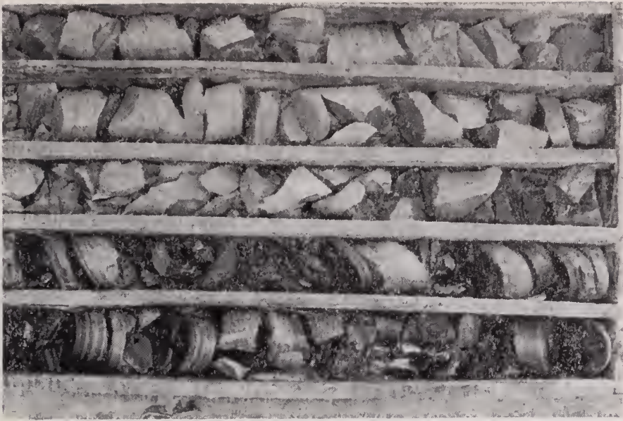
4. ábra. A „felső” lemezes dolomit és a kösszeni márga átmenete az Rzt-1. sz. fúrásban. (Radics L. felvétele) Fig. 4. Transition between the “upper” laminated dolomite and the Kössen marl in borehole Rzt-1
