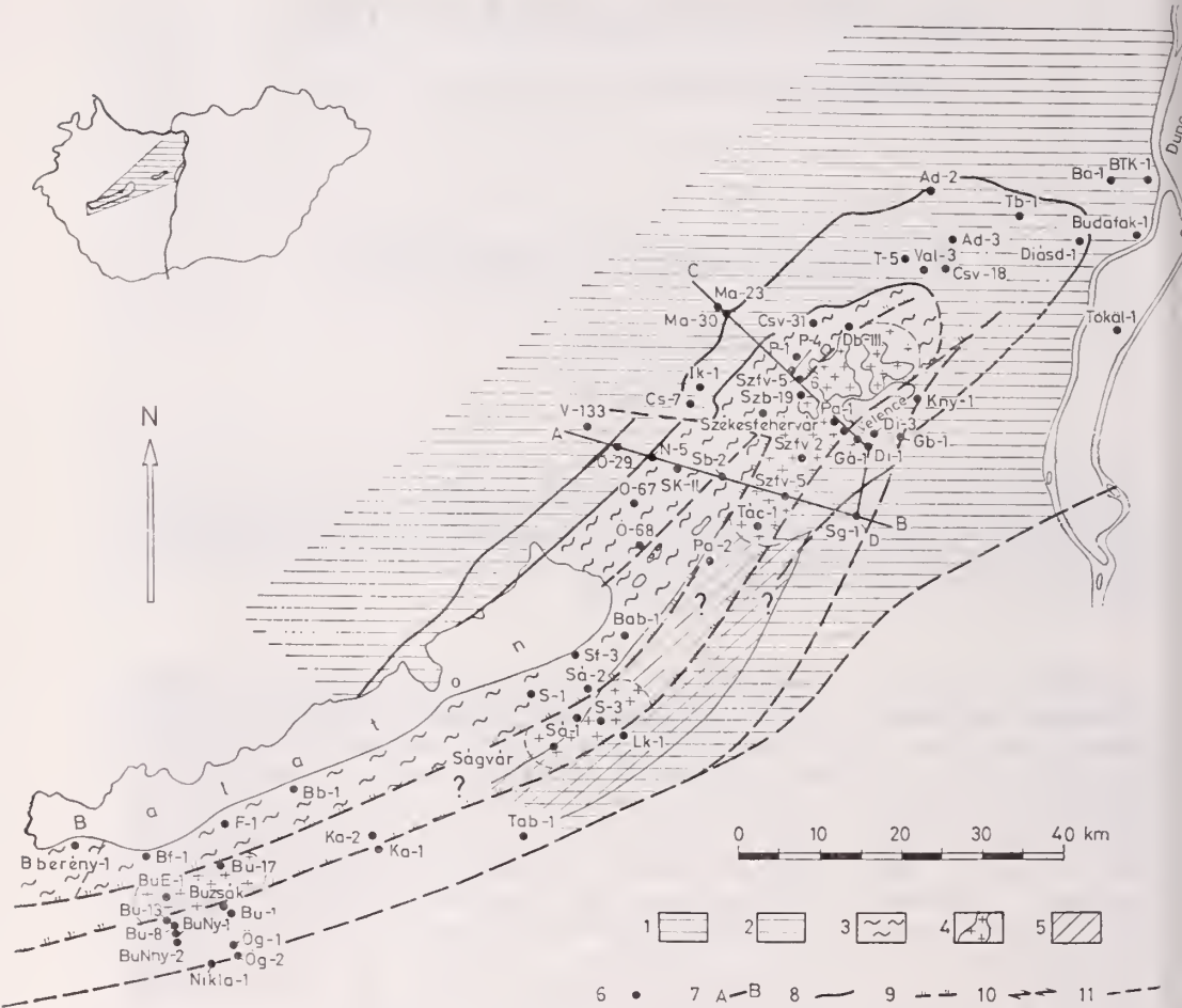
1. ábra. A prekainozoós képződmények szerkezeti vázlatja a Dunántúli-középhegység déli szegélyén. Jelmagyarázat: 1. Középső–felsőtriász képződmények, 2. Alsótriász és permli képződmények, 3. Permnél idősebb paleozoós képződmények, 4. Felsőkarbon gránit és telérközetei, 5. Az aljzatban levő kis ellenállású réteg, 6. Fúrás jele és száma, 7. Földtani szelvény nyomvonala, 8. Földtani határ, 9. Feltolódás, 10. Eltolódás (TELEGGI ROTH vonal), 11. Törés
