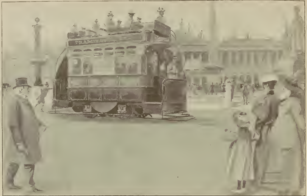
CARRUAJE DE TRANVÍA MOVIDO POR GAS, CONSTRUÍDO POR LA COMPAÑÍA DE ÓMNIBUS DE PARÍS Y ENSAYADO RECIENTEMENTE EN AQUELLA CAPITAL.
