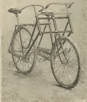
Bicicleta sociable, construída por la «Punnett Cycle Manufacturing Co.»
