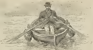
Fig. 1. - Aparato de seguridad inventado por el Sr. Dehnicke, de Berlín, para evitar que los botes zozobren. El bote en su posición normal.
