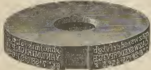
Fig. 2. - Rueda de acero en donde se graban los tipos
