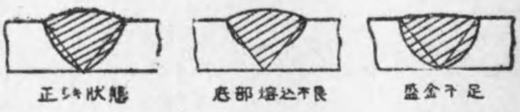
第百二十圖 熔接部ノ狀態
