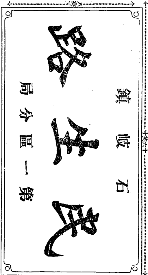
圖三 長方形鐵 質磁而橫 闊十六英 寸高八英 寸白地黑 字沿邊繪 亦用黑色 字用楷書 四角各開 一孔
