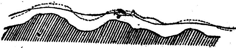
第一圖 與山脈平行之掠地飛行，實線為較有利之路線，虛線為不甚有利之路線
