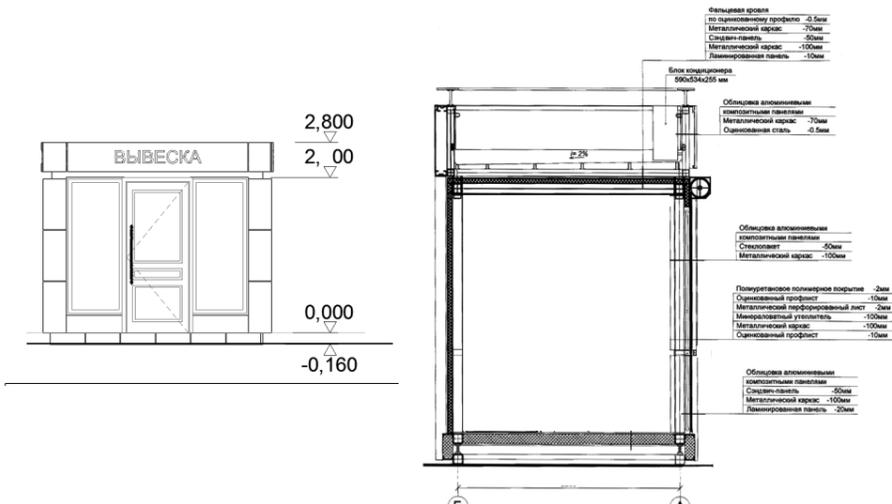
1. Материал несущий каркас конструкции: Оцинкованный прокатный профиль
