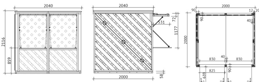
1. Материал несущего каркаса: Сращенная деревянная рейка хвойных пород 8-12% влажности, сечением 40\*40 мм, 40\* 65 мм, 40\*80 мм, 40\*90 мм (ГОСТ 17580-82).
