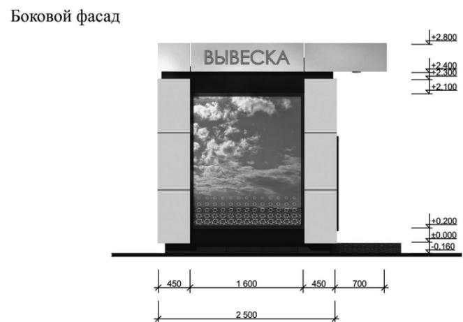
1. Материал несущий каркас конструкции: Оцинкованный прокатный профиль
