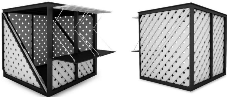
Деревянный контейнер для бахчевых площадью 4 м<sup>2</sup>. Окраска деталей каркаса и деталей наружной обшивки производится эмалью на водной основе для наружных работ в 2 слоя с предварительным нанесением грунта с антисептическим эффектом. Эмаль компонентная, высокопрочная для наружного использования (цвет по RAL 1013 и 8017).
