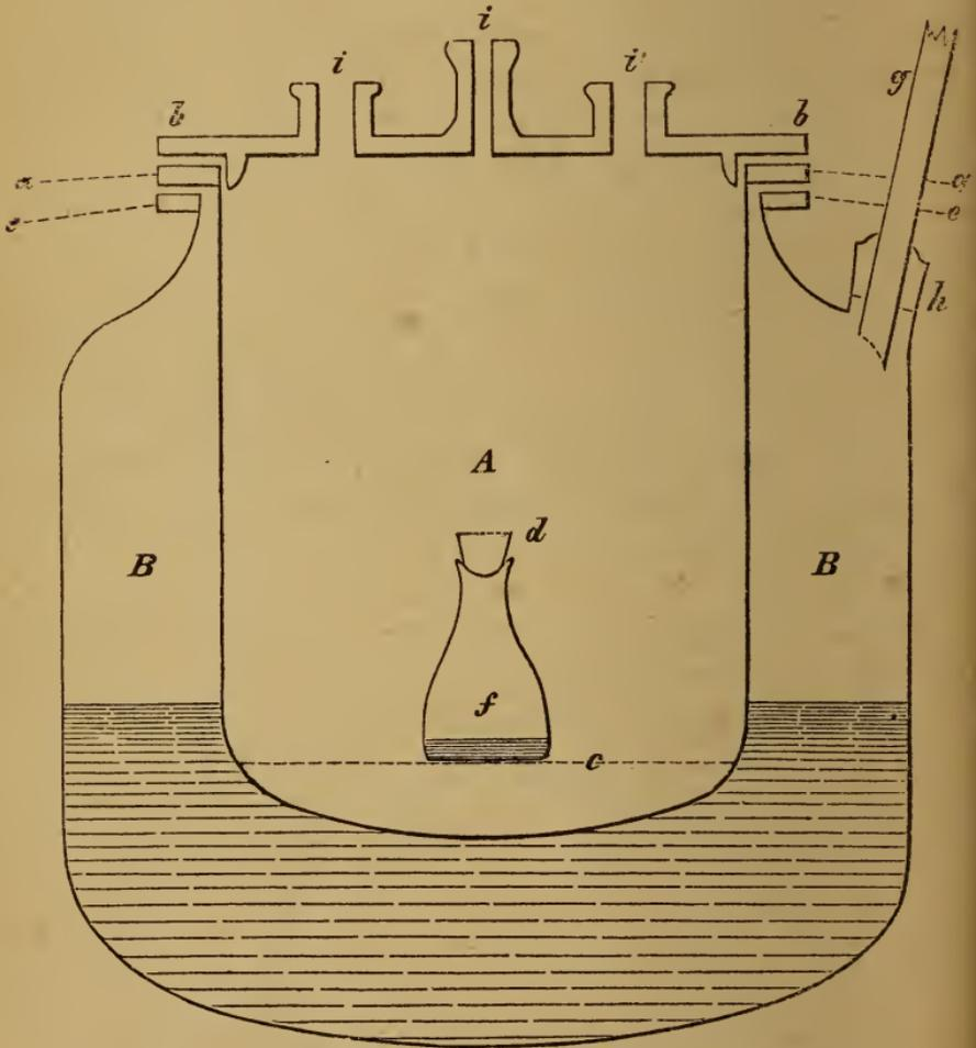
Der Kessel *A* ist in den etwa 100 Mm. weiteren Kessel *B*, an welchen gleichfalls ein, mit der aufsteigenden Seite des Kesselrandes a gut zusammenschliffener Bronzerand *e* angelöthet ist, so daß bei
