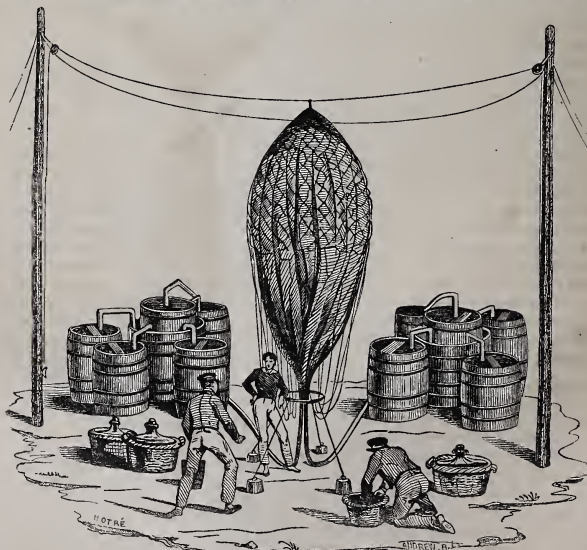
(Appareil pour remplir le ballon par le gaz hydrogène.)
