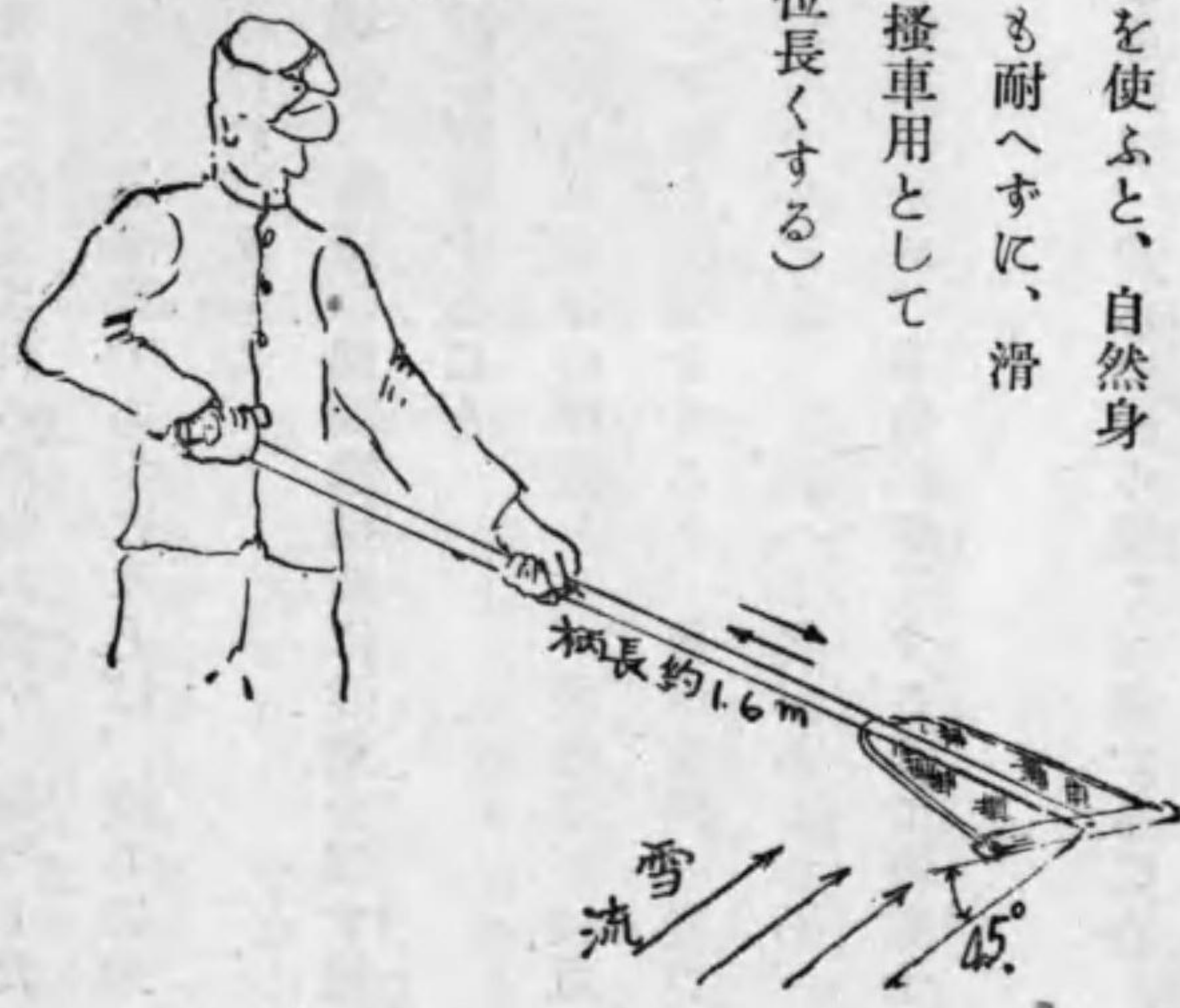
第24圖 搔寄雪搔車に於ける雪搔の安全な使ひ方
