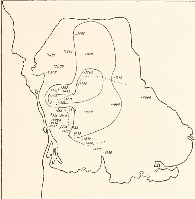
Figur 6. Spezifisches Gewicht des Wassers am Boden. Ausgezogene Linien für 1,15 und 1,17. Die punktierte Linie umgibt die mit Glaubersalz bedeckte Bodenfläche.
