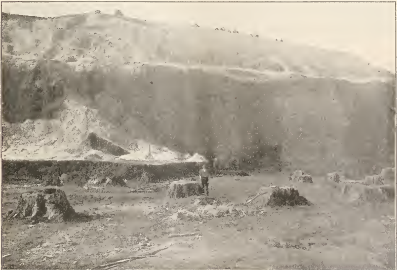
Fig. 10. Blick in eine Braunkohlengrube (Tagebau) bei Gr.-Räschen im Senftenberger Revier. B = Boden des abgebauten Teiles des Kohlenlagers, das bei K im Profil als Wand ansteht. D = Decke des Lagers aus Sand und Ton.
